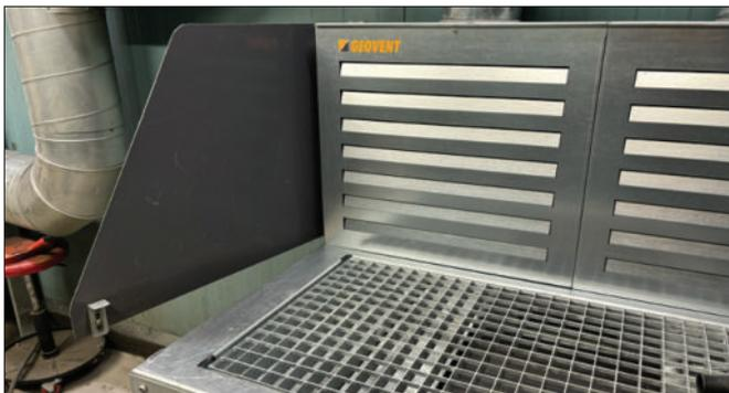
GT Ultra Schweiß- und Schleiftisch mit schwenkbarer Seitenwand
