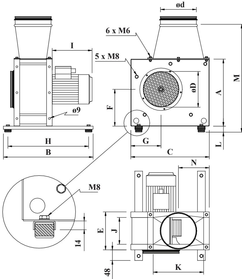
Bei Motorgröße von 0,25 bis 4 kw, ist der Ventilator als Standard mit B5 Flansch geliefert. Bei 4,0 kw und größer oder speziellen Motoren mit höherem Gewicht als Standard, ist der Ventilator mit Flansch/ Fuß B35 Motor geliefert.
