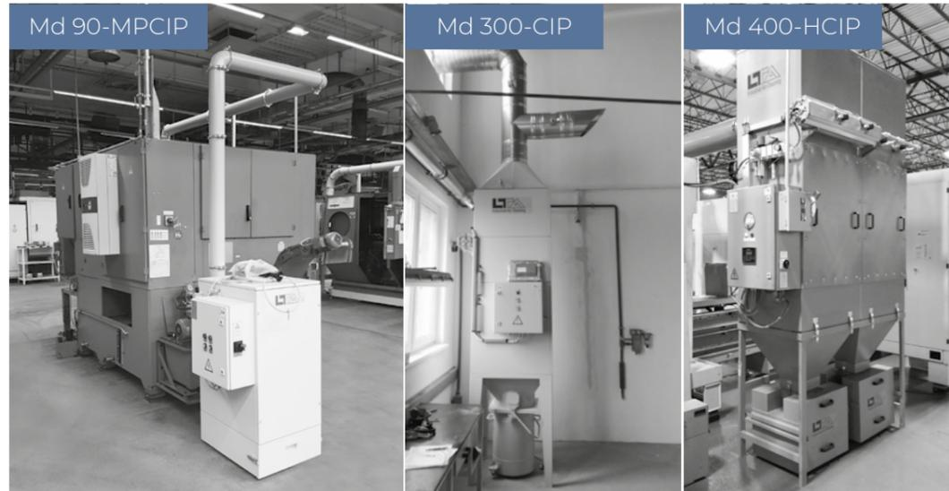
Die mechanischen Feststofffilter für Staub von der LTA Lufttechnik dienen zur Erfassung und Abscheidung von Staub und Rauch jeglicher Art. Die Filtrationssysteme kommen bei einfachen industriellen Anwendungen zum Einsatz, aber genauso bei komplexen industriellen Anforderungen und Filtrationen mit speziellen Kundenvorschriften. Zur Reinigung von gesundheitsschädlichen Partikeln stehen Patronen- und Taschenfilter zur Verfügung.
