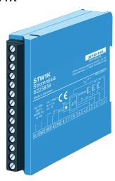
Anlaufautomatik in ODER-Schaltung mit 8 Eingängen. Fließt durch mindestens einen angeschlossenen Wandler ein Strom > 1 A, so zieht das eingebaute Relais (1U) an. Sind die Ströme durch alle Wandler gleich 0 so fällt das Relais mit ca. 10 sec. Zeitverzögerung ab, um den erforderlichen Nachlauf, beispielsweise einer zentralen Absauganlage bei der Holzverarbeitung, zu ermöglichen.
