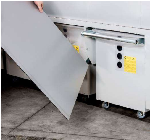
Spänecontainer mit Staubschott
