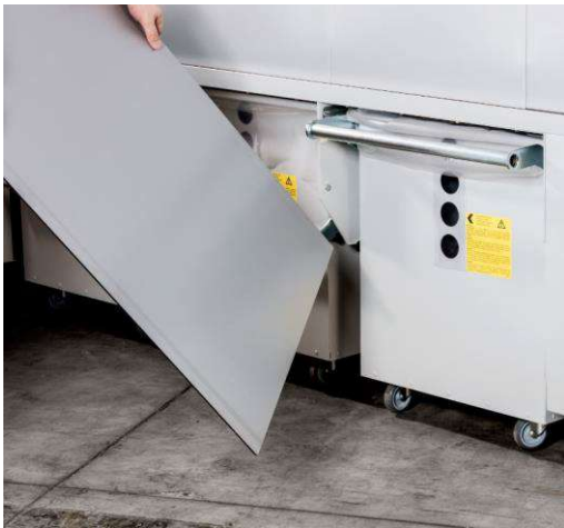
Spänecontainer mit Staubschott
